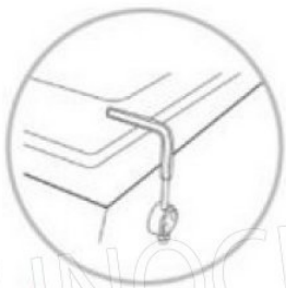
Sistema bloccaggio campana Lid Hook
